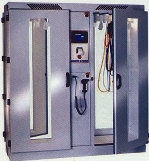
Кабинеты Scope-Store SE оснащены двойной системой фильтрации – каждая позиция размещения эндоскопа оснащена отдельным воздушным насосом. Насосы обеспечивают постоянное продувание каналов эндоскопа стерильным воздухом, прошедшим HEPA-фильтры. Внешняя поверхность эндоскопа и внутреннее пространство камеры обрабатываются воздухом, также пропущенным через HEPA-фильтры. Подача воздуха в насосы системы осуществляется встроенным воздушным компрессором.
