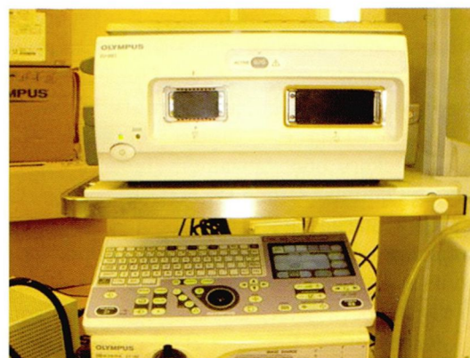
Рис. 4. Комбинированный ультразвуковой центр EU-ME1 (Olympus) с возможностью подключения механических и электронных эхоэндоскопов, а также мини-зондов
