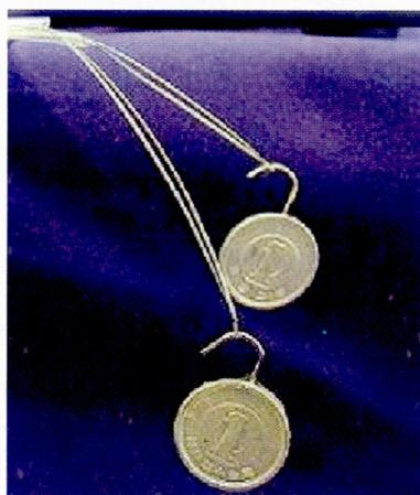
Две петли нагружены одинаковым весом. При этом видно, насколько меньше деформируется под нагрузкой петля SnareMaster (верхняя на фото).
