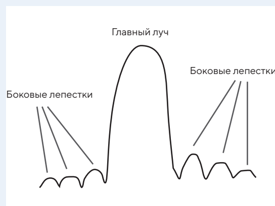
Рис. 4. Артефакты боковых «лепестков» (схема)
