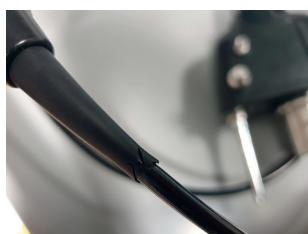
Рисунок 5в. Дефект эндоскопа - трещина оболочки.
