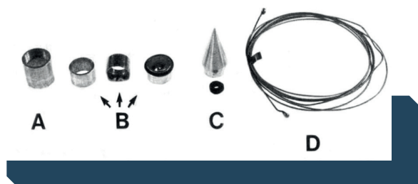
Рисунок 1. Компоненты эндоскопического лигирующего устройства: A корпус цилиндра; B бандажирующие цилиндры (три); C загрузочное устройство с лигирующим кольцом "0"; и D струна. По материалам Van Stiegmann G, Cambre T, Sun JH. A new endoscopic elastic band ligating device. Gastrointest Endosc. 1986 Jun;32(3):230-3. doi: 10.1016/s0016-5107(86)71815-4.
